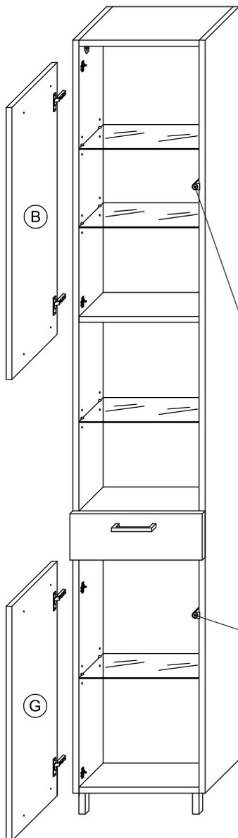
T11 Bei Türmontage das Scharnier einhängen, bis Anschlag öffnen und anschließend festschrauben.
